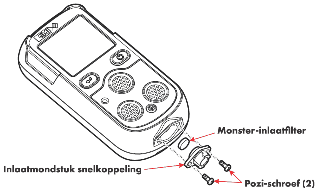
Afbeelding 53: RMonsterinlaatfilter (stoffilter) vervangen
