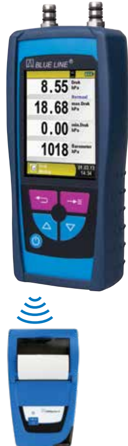
fig. 7: In de juiste stand brengen van de beide apparaten bij het afdrucken
