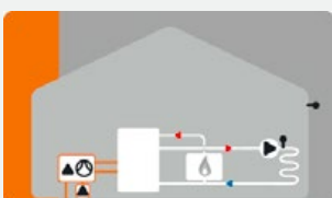
Réservoir combiné avec système de chauffage direct avec fonctions supplémentaires de pompe à glycol et compresseur
