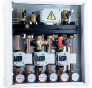
Kit préassemblé composé d'un coffret, d'un collecteur avec séparateur hydraulique désactivable, d'un boîtier électrique précâblé, de 2 ou 3 groupes DN20 au choix : à distribution directe 71G.DN20, à régulation thermostatique 72G.DN20, motorisé à 3 points 73G.DN20. Isolation 43D.02 en option.
