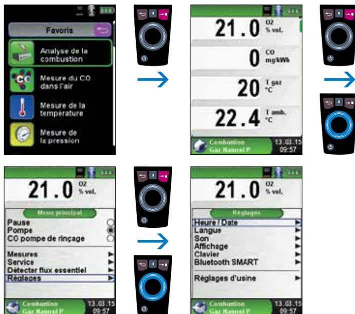
fig. 58 : Accès à la fonction « Réglages » via le Menu principal (ex. : Combustion)
